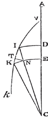
圖2：向心力 IN 與其沿位移方向分量 IT 之關係圖 資料來源：引自 Newton's Principia , by Newton, 1687/1846, p. 165。
