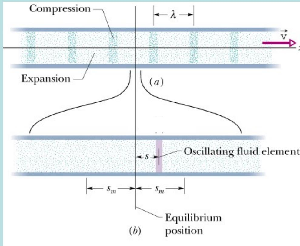
以 $x$ 為平衡點的氣體分子，在時間 $t$ 時的沿 $x$ 軸的位移： $\Delta x(x, t)$ 或 $s(x, t)$ 。
