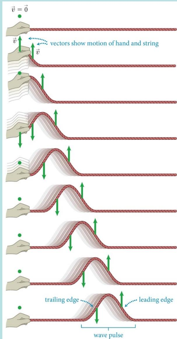
將一條緊拉的弦，在垂直方向移動作一個脈衝。
