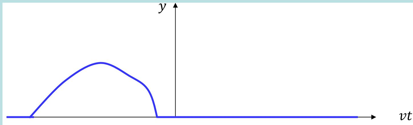
波函數  $y(x, t) = f(x - vt)$  在固定時間及固定位置後，得到同一個函數  $f$  ！
