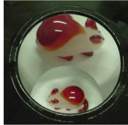
相片十五 經啟動旋轉式投射燈之電源開關時玻璃老鼠的放大實像也隨著轉動 (下：實物，上：漂浮實像)
