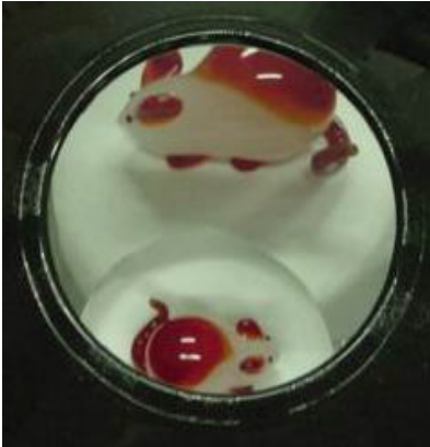
相片十五 經啟動旋轉式投射燈之電源開關時玻璃老鼠的放大實像也隨著轉動 (下：實物，上：漂浮實像)
