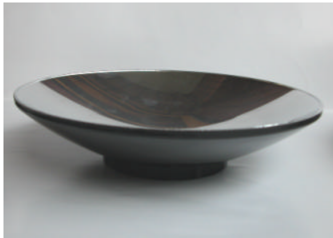
相片六 立體飄浮魔鏡之底座(下面的凹面鏡之內徑 22.0 cm，外徑 22.4 cm)
