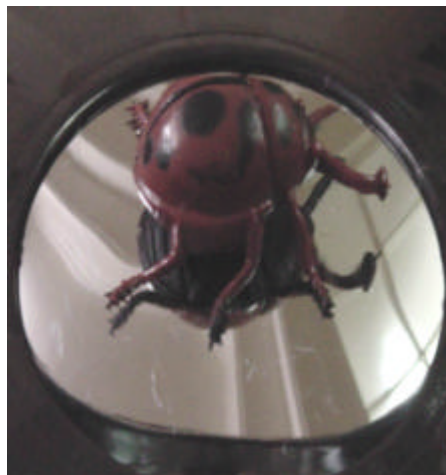
相片十六 塑膠金龜子的實像飄浮在立體飄浮魔鏡上面凹面鏡中央的小孔上
